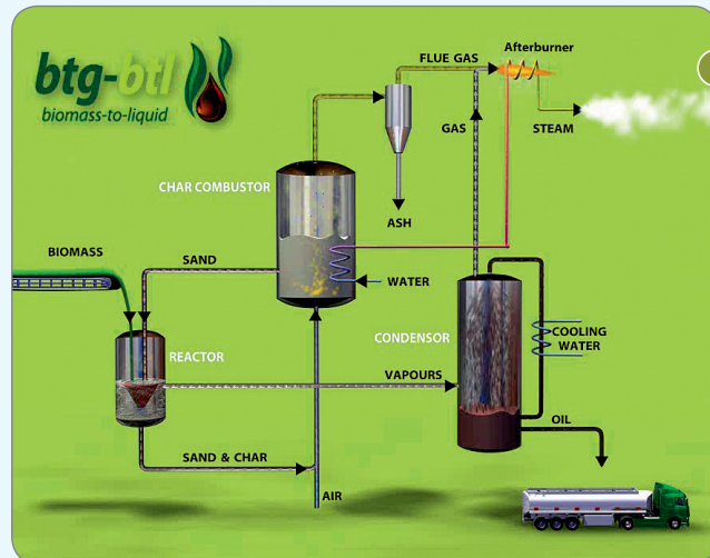
2 Schematische weergave pyrolyse proces van BTG-BTL
